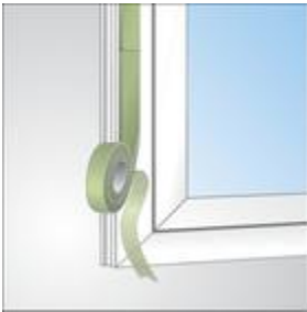
Bild 3: Stumpfstoß bei der Fenstermontage
