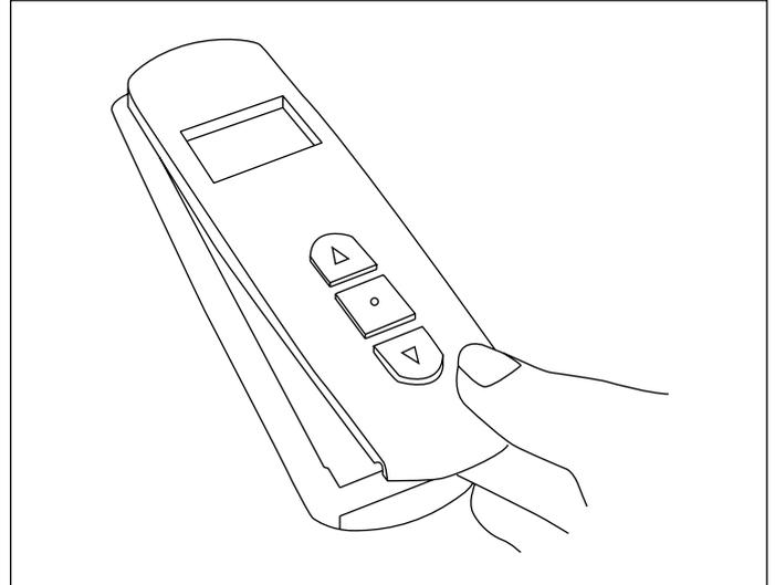
5. Drücken Sie das Vorderteil des Handsenders vorsichtig in den Gummirand der hinteren Abdeckung.
