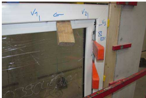
Bild 11 Schäden aus der manuellen Prüfung auf der Griffseite oben
