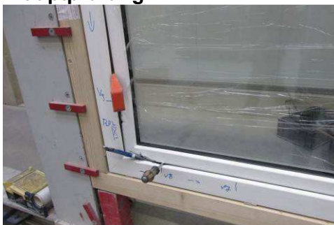
Bild 19 Schäden aus der manuellen Prüfung am Ecklager
