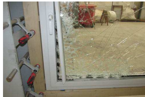
Bild 18 Schäden aus der manuellen Prüfung der Glasanbindung (innenseitig)
