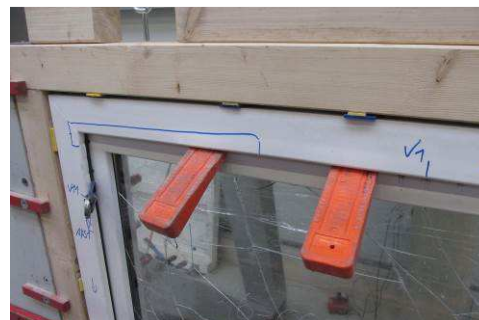
Bild 14 Schäden aus der manuellen Prüfung am Scherenlager
