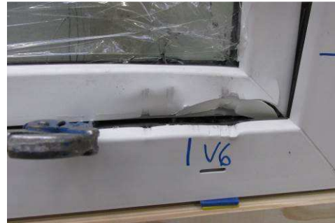
Bild 10 Schäden aus der manuellen Prüfung auf der Griffseite unten
