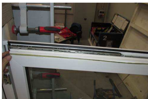
Bild 7 Scherenlager des Probekörpers
